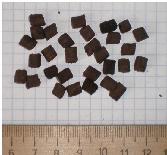
Рис. 2. Фотография гранул органическо-минерального сорбента
