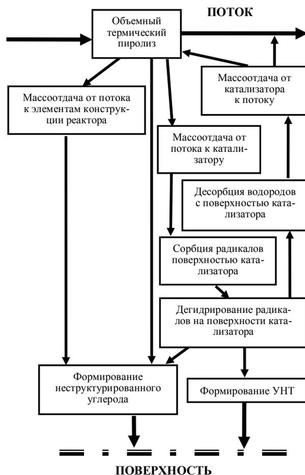
Рис. 1. Структурная схема основных процессов синтеза углеродных нанотрубок
