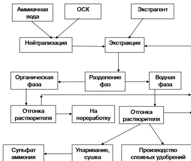
Рис. Принципиальная схема переработки ОСК с получением удобрений
