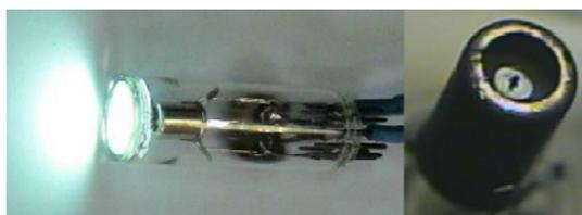
Рис. 5. Лабораторный образец АКЛ с бело-голубым спектром свечения и его КМУ
