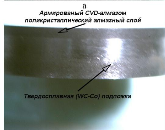
Рис. 3. Гибридная АТП с алмазным слоем, спеченным из микропорошка алмаза Попигайского месторождения, армированным пластинами CVD алмаза: а – вид сверху; б – вид сбоку
