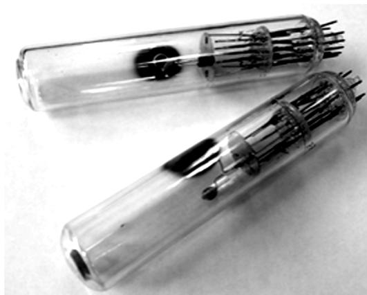
Рис. 3. Отпаянные электровакуумные приборы для проведения долговременных испытаний УВ
