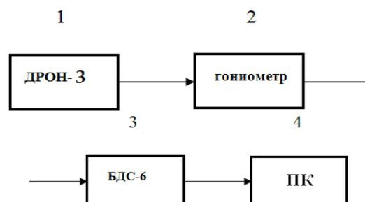
Рис. 2. Схема установки для исследования порового пространства мембран методом малоуглового рентгеновского рассеяния: 1 – питающий аппарат ДРОН-3, 2 – малоугловой гониометр, 3 – счетчик БДС-6, 4 – персональный компьютер
